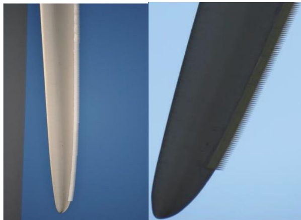
Illustrations du montage des serrations sur les pales d'une éolienne
